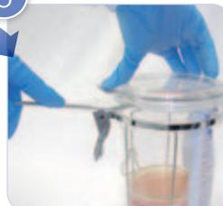
Ocasionalmente se puede generar vacío en la jarra después de la anaerobiosis, produciendo una presión negativa que impida la apertura de la jarra. Esto puede solucionarse utilizando un pequeño objeto para hacer palanca (como una espátula).
